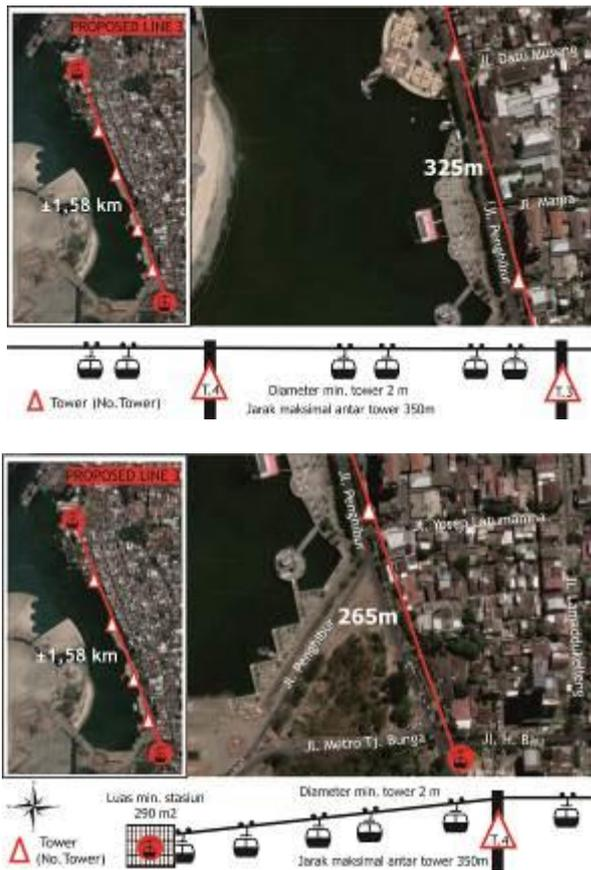
Gambar 18. Desain Peletakan Tower untuk Rute Alternatif 3
