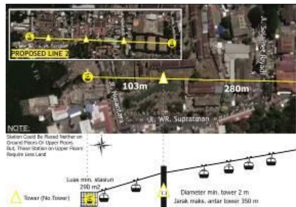
Gambar 17. Desain Peletakan tower untuk rute alternatif 2
