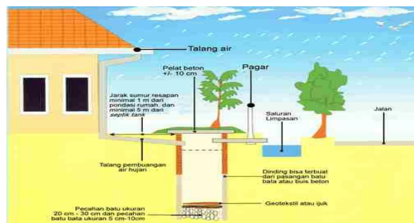
Gambar 2. Sumur resapan Sumber: Wahyuningsih, 2011
