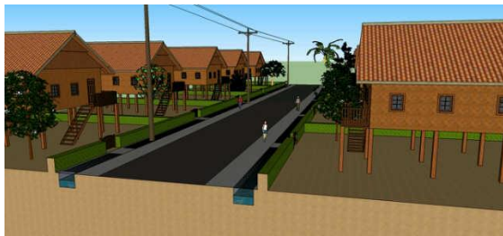
Gambar 18. Penataan saluran drainase tersier
