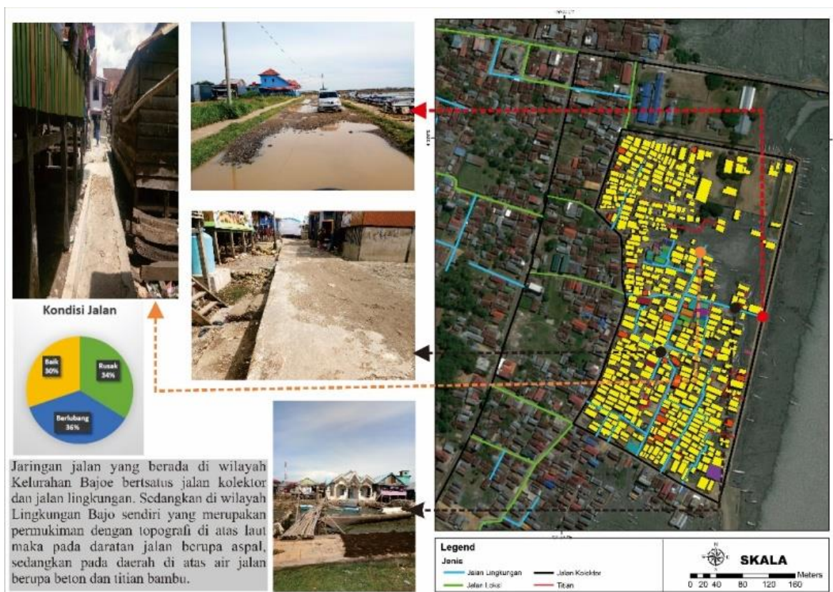
Gambar 8 Peta Analisis Kondisi Fisik Jalan di Lingkungan Bajo
