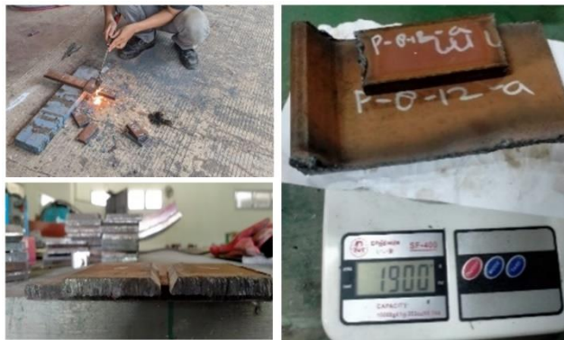
Gambar 2. Pemotongan dan penimbangan awal spesimen
