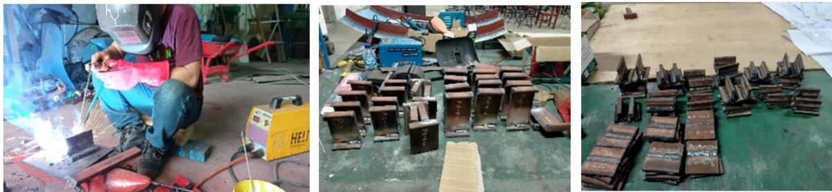
Gambar 4. Proses dan hasil pengelasan spesimen
