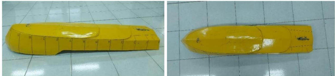
Gambar 6. Tampak Bawah dan Tampak Samping Model Kapal Berlambung Deadrise Angle 10° dan 2 Stepped U .
