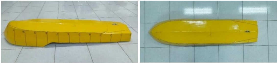
Gambar 5. Tampak Bawah dan Tampak Samping Model Kapal Berlambung Deadrise Angle 10° dan 1 Stepped U .
