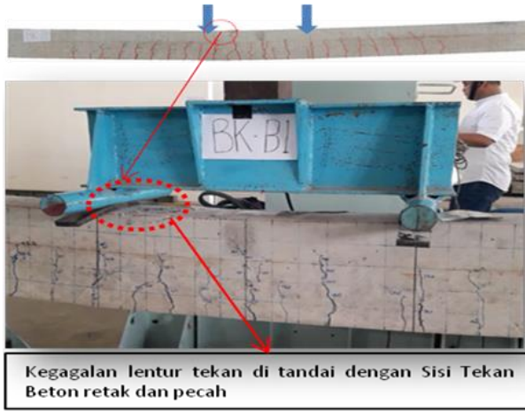
Gambar 11. Mode keruntuhan Balok Kontrol (BK)
