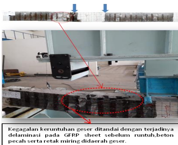
Gambar 13. Mode keruntuhan balok BFTS
