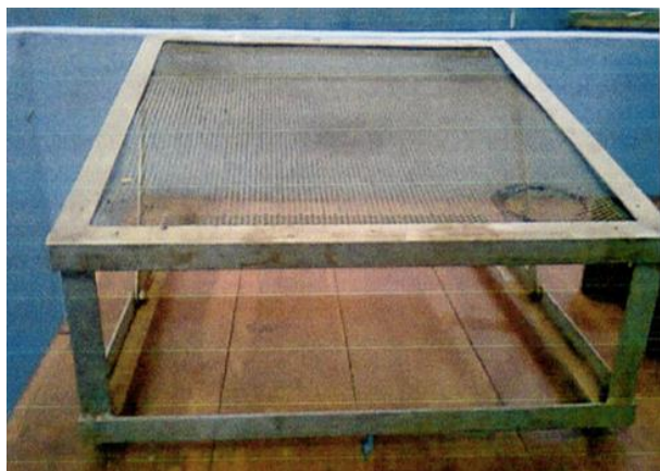
Gambar 1. Alat Pengatur Kemiringan Lereng
