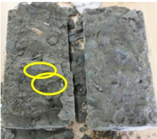
Gambar 6. Kondisi batu pecah terbelah pada sampel 0% wet curing hari ke 14 pada pengujian kuat tarik belah
