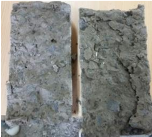
Gambar 5. Sampel 2,5% wet curing hari ke 14 hampir tidak terdapat serat kawat bendrat pada pengujian kuat tarik belah
