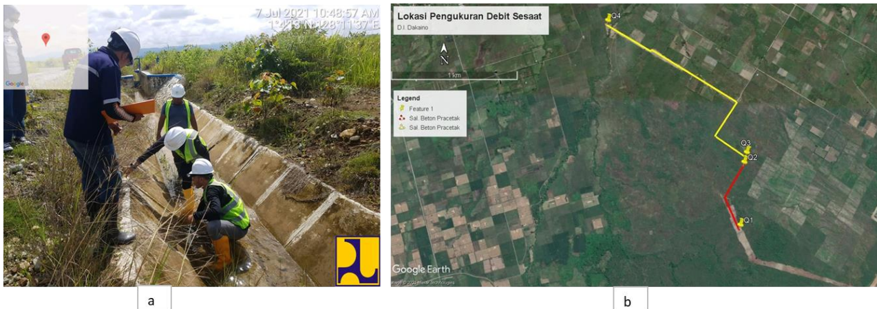
Gambar 2. a) Pengukuran geometri saluran dan debit pada saluran irigasi D.I Dakaino b) Peta lokasi
