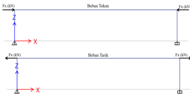
Gambar 3. Arah pembebanan pada model struktur plane frame
