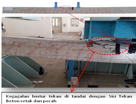
Gambar 12. Mode keruntuhan balok BFS
