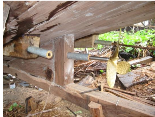
Gambar 1. Model buritan kapal kayu tradisional dan sistem propulsi yang digunakan
