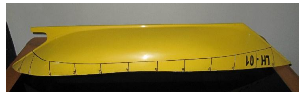
Gambar 3. Model pengujian kapal kayu tradisional Tipe Pinisi yang digunakan
