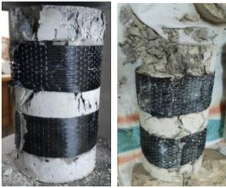
Gambar 11. Pola retak benda uji AB2
