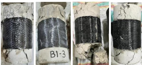
Gambar 8. Pola retak benda uji T
