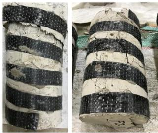
Gambar 12. Pola retak benda uji SP
