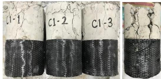
Gambar 9. Pola retak benda Uji B
