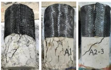
Gambar 7. Pola retak benda uji A
