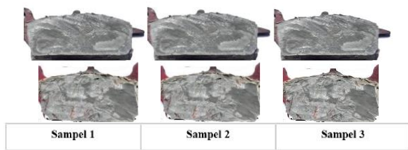
Gambar 5. Spesimen kampas rem setelah uji keausan
