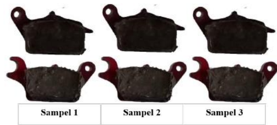
Gambar 3. Spesimen kampas rem sebelum uji keausan
