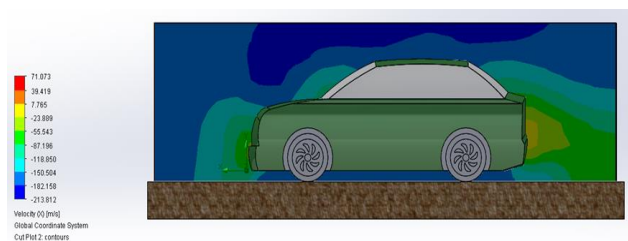
Gambar 5. Tampilan cut plot kecepatan 180 km/jam dengan ground clearance 140 mm
