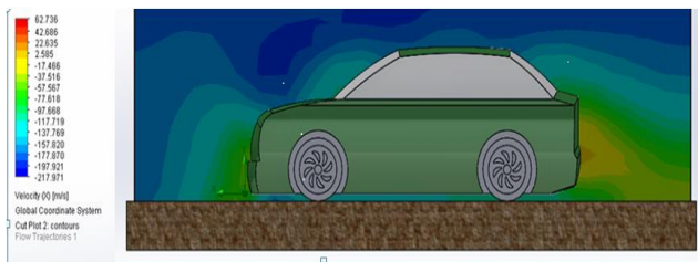
Gambar 6. Tampilan cut plot kecepatan 180 km/jam dengan ground clearance 80 mm
