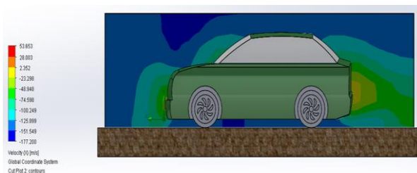
Gambar 3. Tampilan cut plot kecepatan 150 km/jam dengan ground clearance 140 mm
