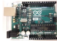
Figure 2. Microcontroller (Arduino UNO)
