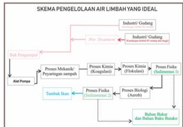
Gambar 3. Skema tahapan pengolahan air limbah eksisting
